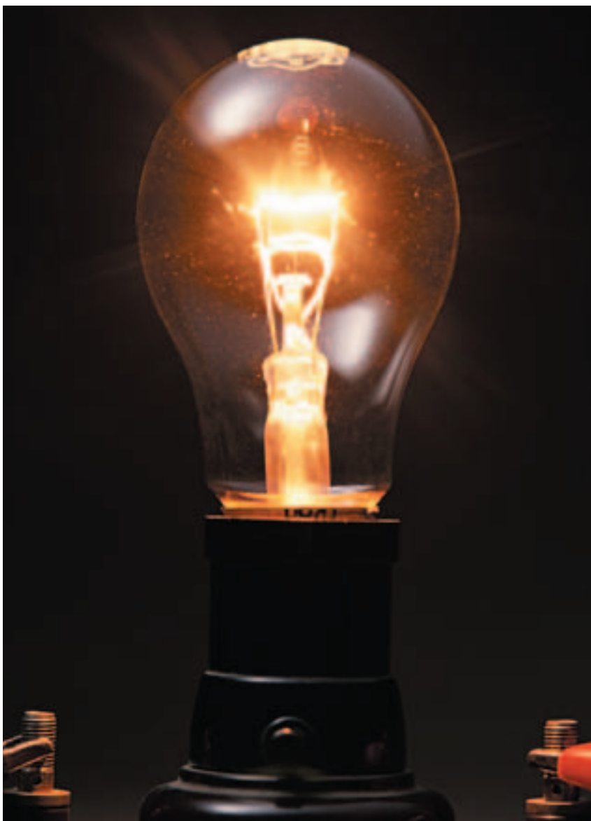
用燈泡亮不亮來檢驗溶液的導電行為是不靈敏的，最好還是以電流計來取代燈泡。
